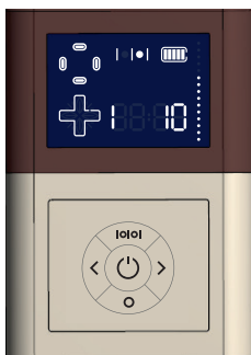
Рисунок 3 – Расположение кнопок управления и дисплея на аппарате
